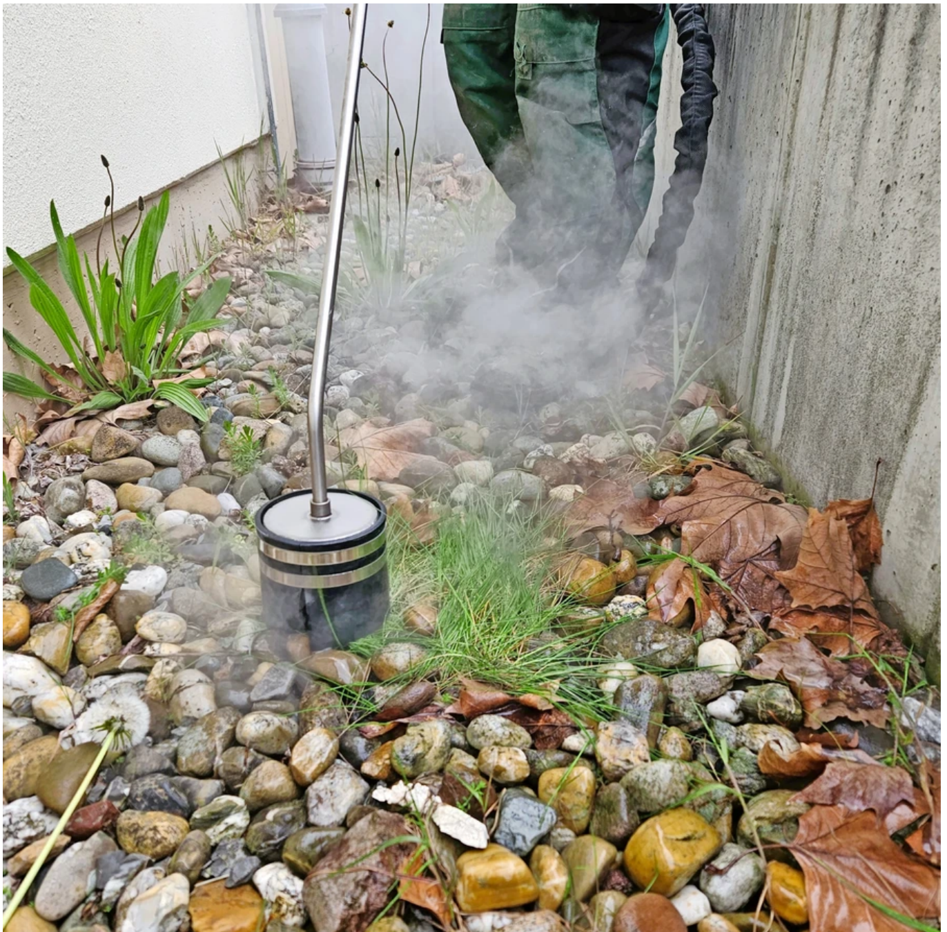
Auf unregelmäßigen Oberflächen wie beispielsweise in der Kiestraufe kommt die Zylinderlanze mit Gummimanschette zum Einsatz. © Garten Stahl
